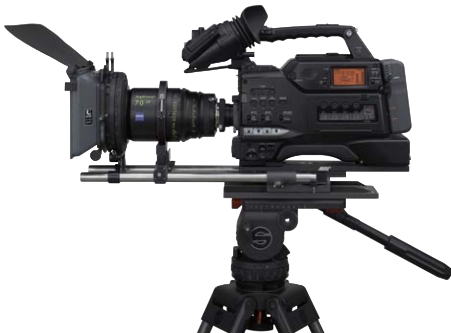
Lente Cinema na HVR-S270N com um adaptador
